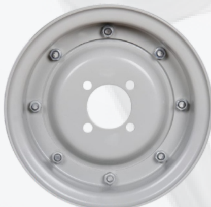
Wheel Rim Size : 3.00x8" Stud & PCD : 4x70 mm
