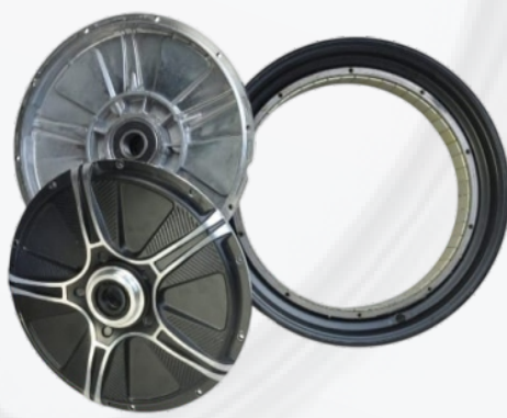
Hub Motor Rim Size : MT 2.15x12" Inner Dia. : 260 mm PCD : 267 mm Width : 40 mm & 50 mm
